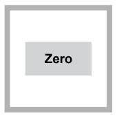
**10.** Push **ZERO**. The display shows 0.0 mg/L NO<sub>3</sub><sup>-</sup>–N.
